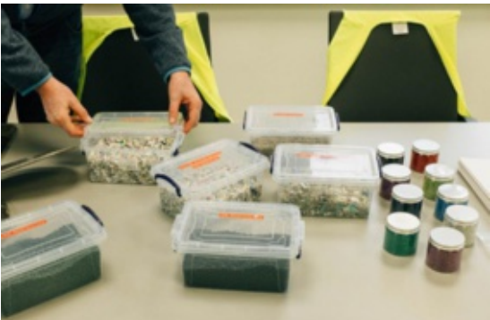
På Vogt Plastics anlegg blir norsk plastemballasje til re-granulat, som igjen er råstoff til nye plastprodukter, som hagemøbler og vannkanner.
