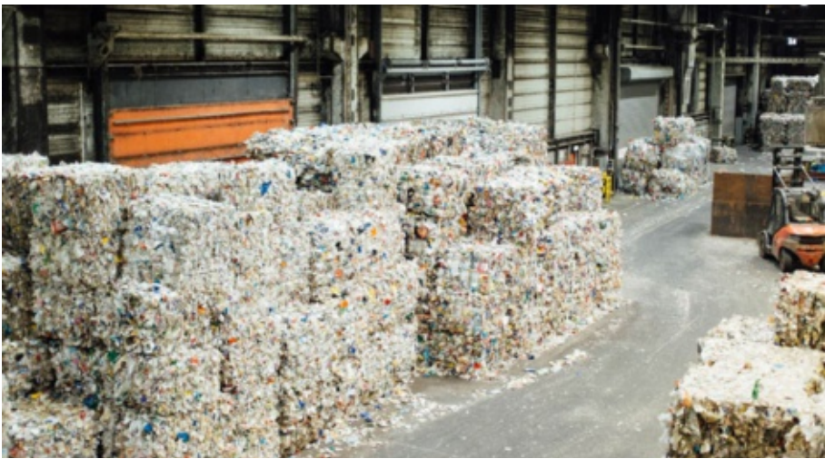
På Vogt Plastics anlegg blir norsk plastemballasje til re-granulat, som igjen er råstoff til nye plastprodukter, som hagemøbler og vannkanner.
